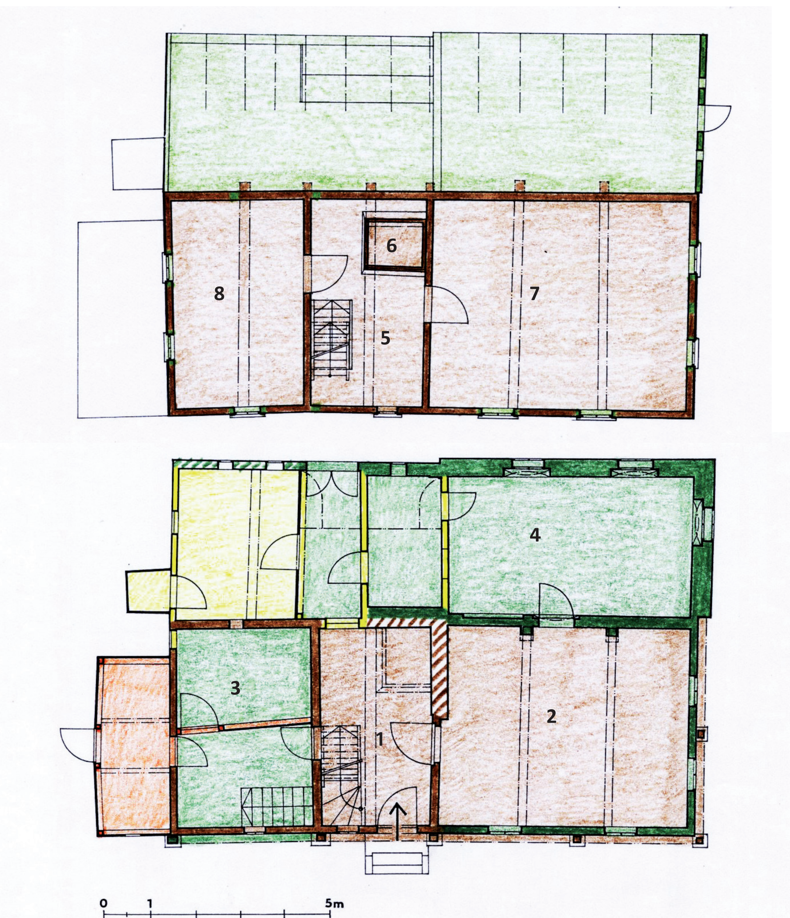
←↙ Pracovní verze půdorysu přízemí a patra domu pro grafickou část stavebněhistorického průzkumu. 1–síň, 2–světnice, 3–komora (druhotně rozdělená), 4–světnička, 5–hor. síň, 6–dřevohliněný komín, 7–hor. světnice, 8–hor. komora. Barevné vyhodnocení: hnědá–2. pol. 17.–18. stol., zelená–1. pol. 19. stol., oranžová–2. pol. 19. stol., žlutá–20. stol. JŠ 1997
