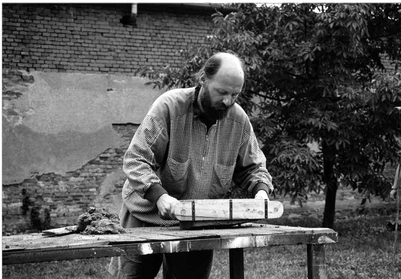
Obr. 10) Ukázka výroby nepálených cihel v rámci Hliněných dní v Příkazích (foto Jan Kříž 1998).
